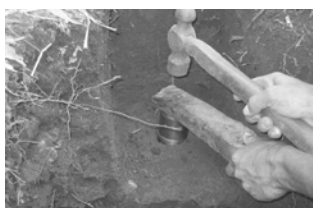
Penetración de los cilindros
