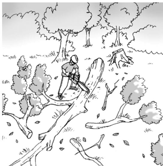
Figura 30. Corte de árbol en segmentos para medición de un tronco para desarrollo de ecuación alométrica
