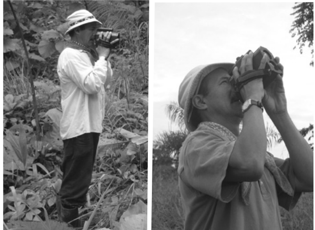
Figura 22. Medición de la altura utilizando el clinómetro electrónico Vertex
