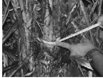
Medición de diámetro basal
