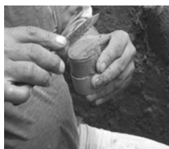
Forma de preparar el cilindro para obtener la muestra final de suelo
