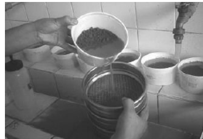
Figura 41. Proceso de tamizado y lavado de raíces finas en laboratorio Fuente: Ramos 2003.
